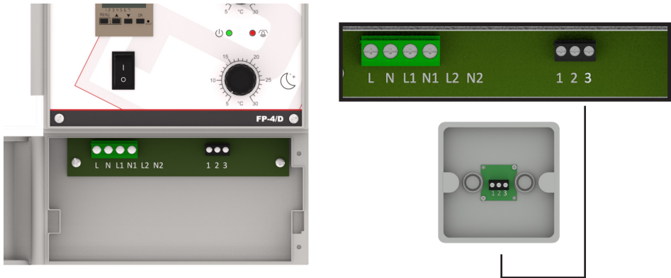
Bild 3: Anschlusspunkte des Temperaturreglers (Reihenklemme)
